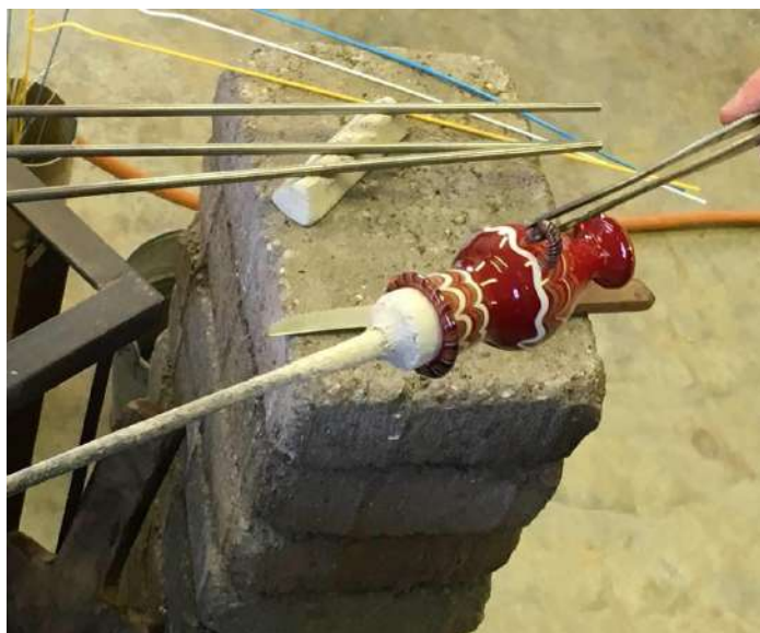
Рисунок 2. Технологическая реконструкция метода навивки стекла на сердечник Figure 2. Technological reconstruction of the method of winding glass on the core
