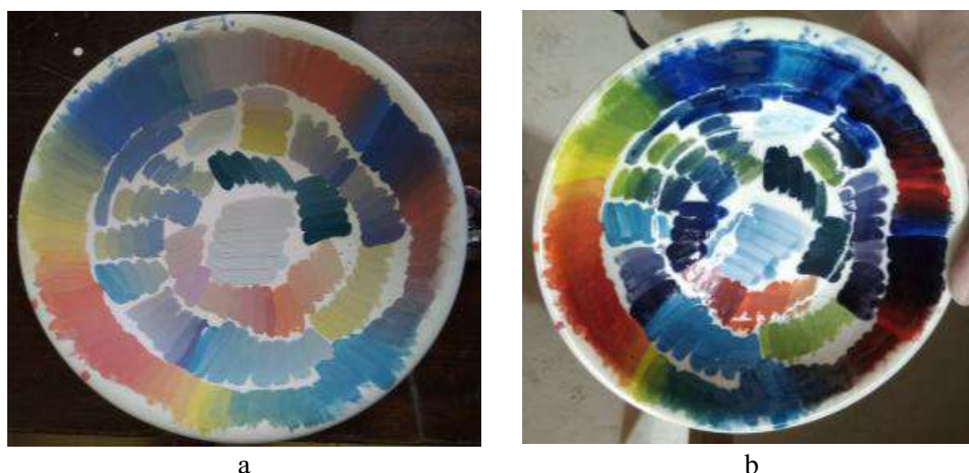
Рисунок 7. Пробники пигментов а – до обжига, б – после обжига Figure 7. Pigment Samples a - before calcination, b - after calcination
