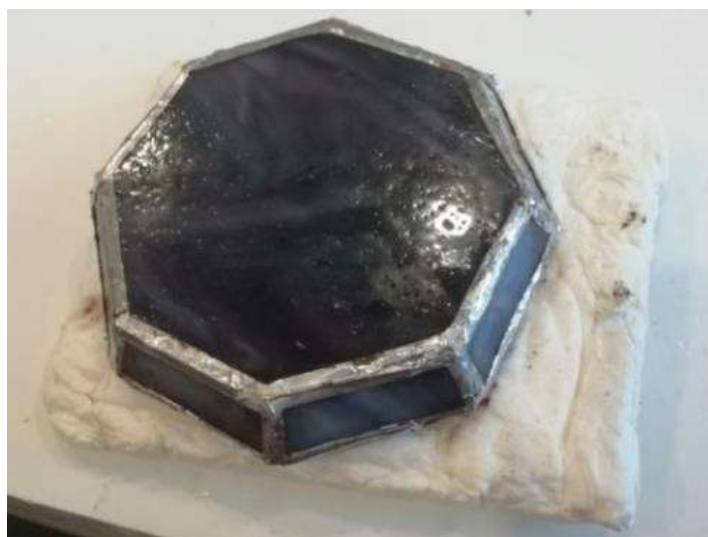
Рисунок 4. Процесс пайки на болванке Figure 4. Soldering using the blank
