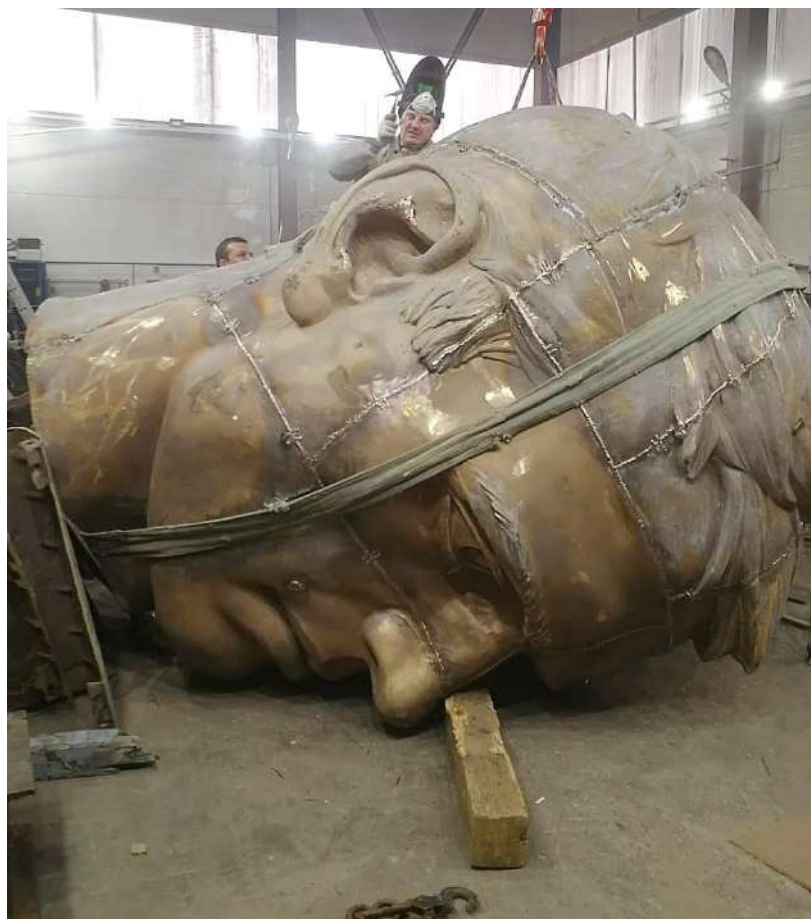
Рисунок 8. Сварка отлитой головы по частям Figure 8. Welding of the cast head in parts
