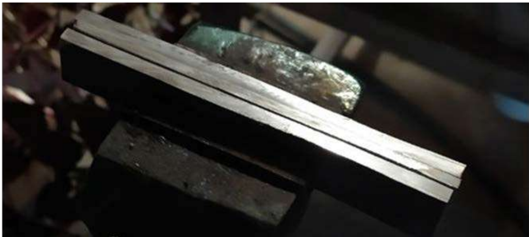
Рисунок 3. Собранные в «ламинат» листовые заготовки из стали марок 95X18 и PGK Figure 3. Sheet blanks made of steel grades 95X18 and PGK assembled into a «laminated»
