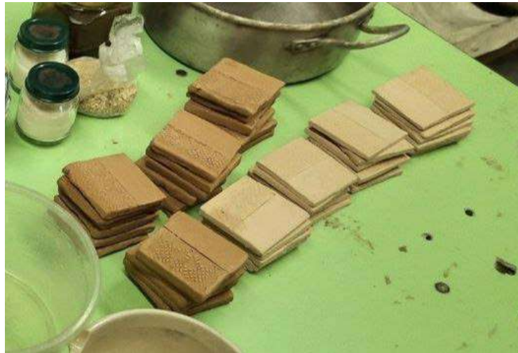
Рисунок 1. Подготовленные образцы после утильного обжига, демонстрация цвета Figure 1. Prepared samples after the first firing, color demonstration
