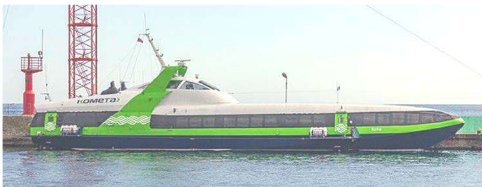
Рисунок 2. Маломестное пассажирское судно на подводных крыльях «Комета 120М» Figure 2. Small passenger hydrofoil vessel "Comet 120M"
