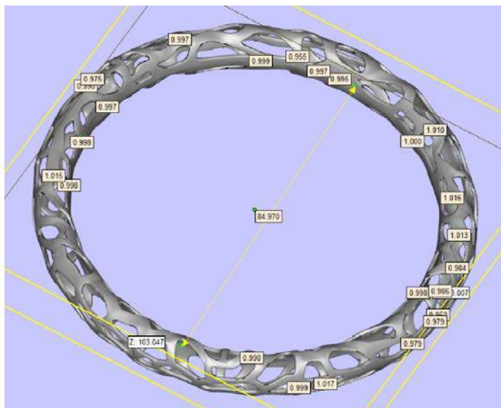
Рисунок 7. Проверка толщины сечений Figure 7. Thickness control
