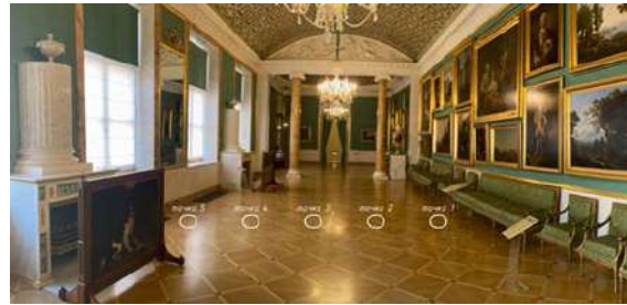
Рисунок 9. Измерение освещённости и расчёта КЕО от объекта к окну Figure 9. Measurement of illumination and calculation of the daylight factor from the object to the window
