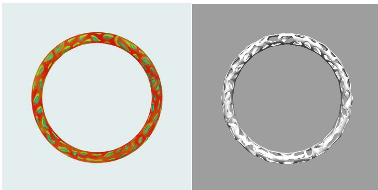
Рисунок 6. Формируемые напряжения в модели под нагрузкой (слева) и вариант паттерна оптимизации после постобработки (справа)
