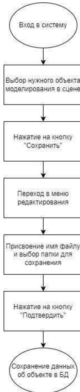
Рисунок 1. Алгоритм сохранения выбранных объектов моделирования Figure 1. Algorithm for saving selected modeling objects
