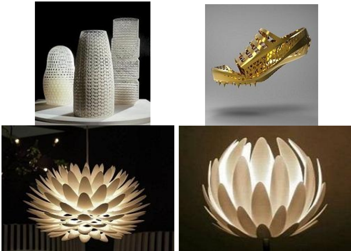
Рисунок 6. Изделия, напечатанные методом селективного лазерного спекания
