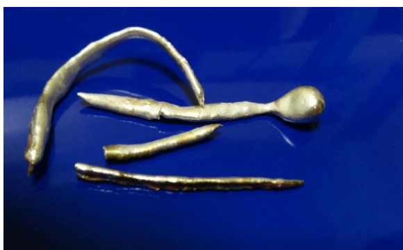
Рисунок 6. Отливки серебра. Условия - m_{Ag} - 20 г, 50л воды и 50 мл спирта, водяная струя.
