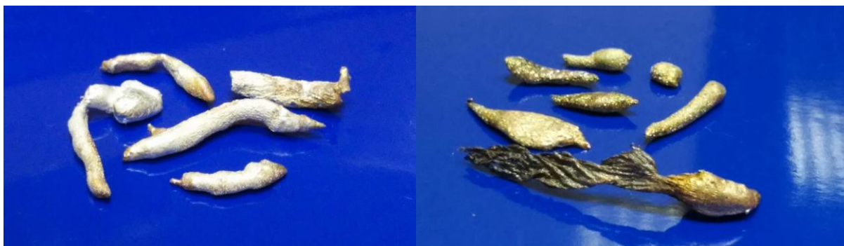
Рисунок 5. Отливки серебра. Условия - m_{Ag} - 100 г, л воды и 50 мл спирта, водяная струя.
