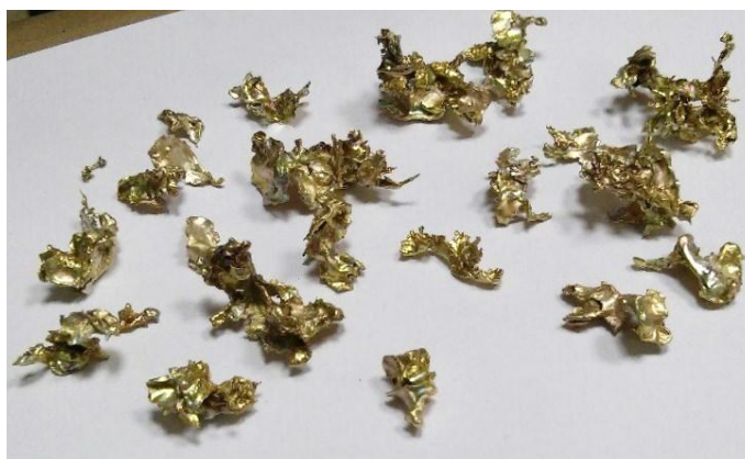
Рисунок 2. Отливки серебра, полученные методом литья в воду. ( m_{Ag} - 100 г, V_{ж} 50л)
