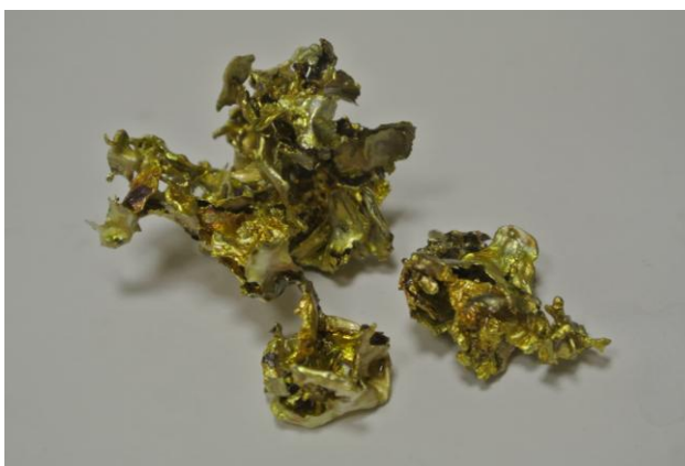
Рисунок 11. Отливки серебра. Условия - m_{Ag} - 20 г, 50л воды и 150 мл масла: a – быстрое литье; б – медленное литье
