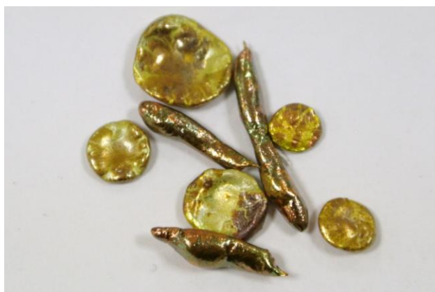
Рисунок 1. Отливки серебра, полученные методом литья в воду. ( m_{Ag} - 20 г, V_{ж} 3л)
