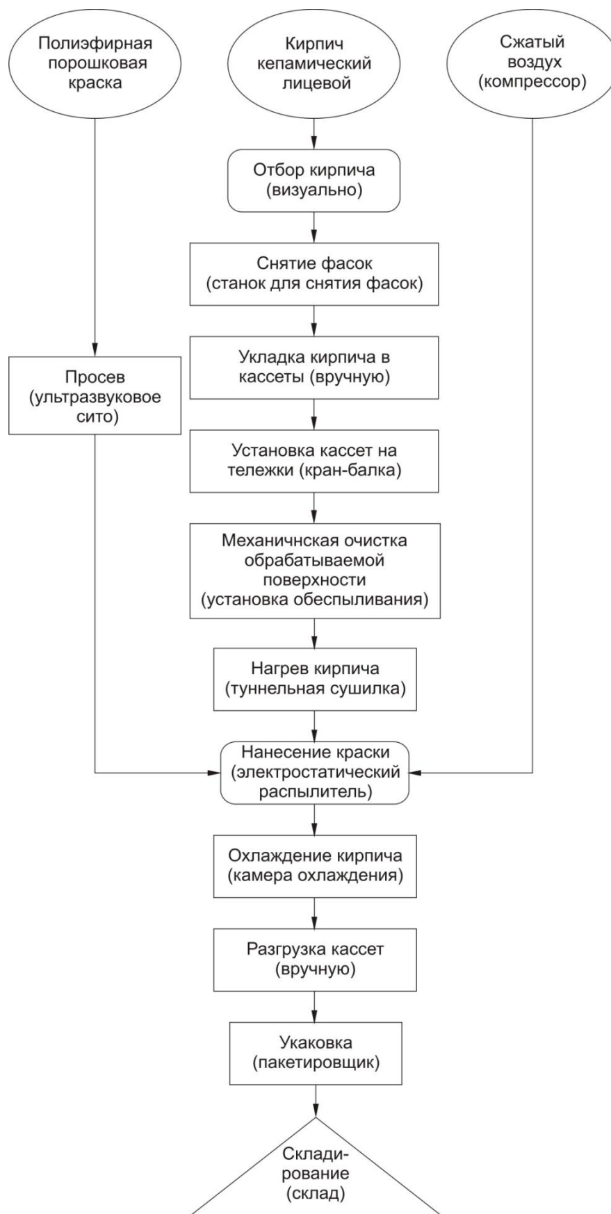
Рисунок 7. Технологическая схема нанесения полимерного покрытия на керамический кирпич
