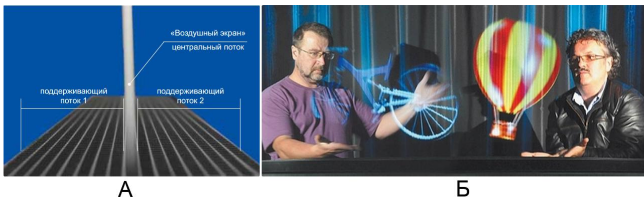
Рисунок 1. PoliVizor: а — принцип работы устройства, б — устройство в действии
