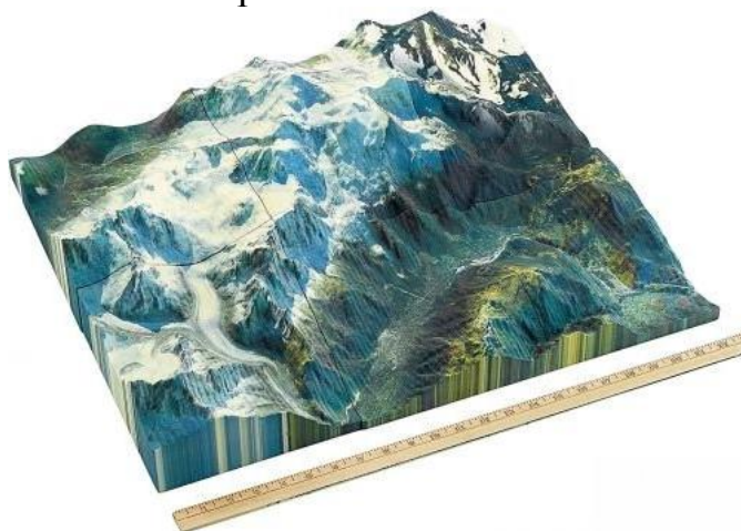
Рисунок 5. Модель, изготовленная методом послойного формирования из листового материала
