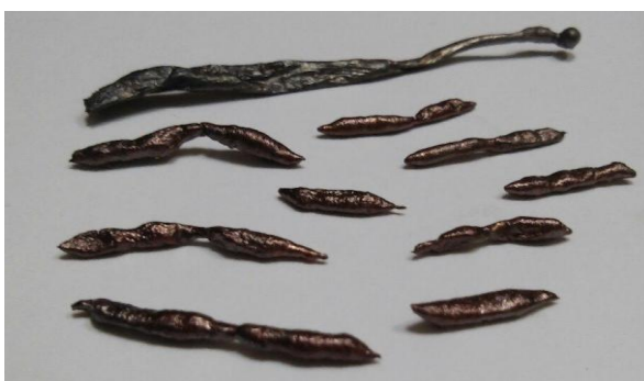
Рисунок 10. Отливки серебра. Условия - m_{Ag} - 20 г, 50л воды и 150 мл масла
