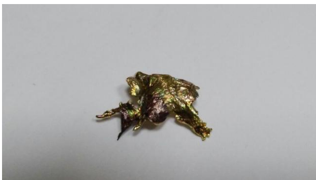
Рисунок 9. Отливки серебра. Условия - m_{Ag} - 100 г., объем жидкости – 50л и 150 мл масла: a – Оливки при литье средней скорости; б – Отливки при медленном литье
