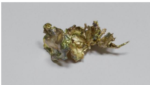
Рисунок 9. Отливки серебра. Условия - m_{Ag} - 100 г., объем жидкости – 50л и 150 мл масла: a – Оливки при литье средней скорости; б – Отливки при медленном литье
