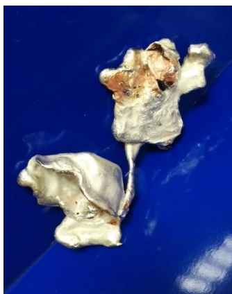
Рисунок 3. Отливки серебра. Условия - m_{Ag} - 20 г, 3 л воды и 50 мл спирта, воронка.
