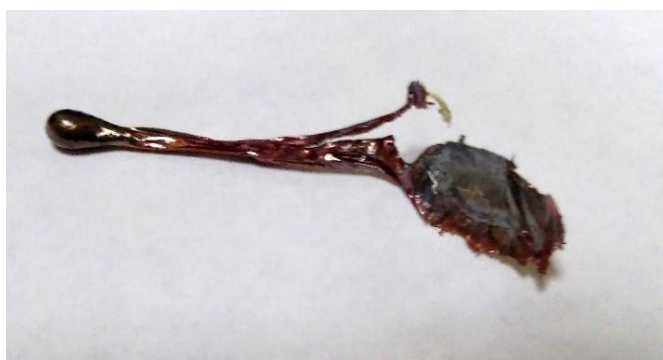
Рисунок 7. Отливки серебра. Условия - m_{Ag} - 20 г, 50л воды и 50 мл спирта, водяная струя, охлажденный металл.
