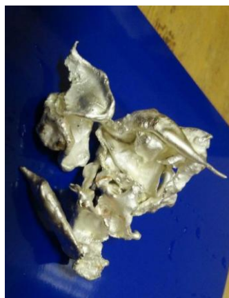
Рисунок 4. Отливки серебра. Условия m_{Ag} - 100 г, 50л воды и 50 мл спирта, воронка.
