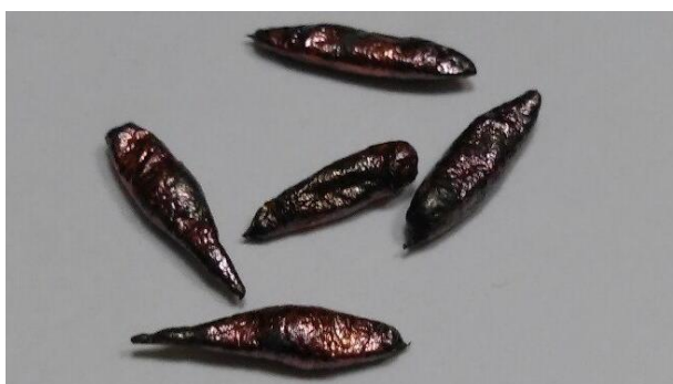
Рисунок 10. Отливки серебра. Условия - m_{Ag} - 20 г, 50л воды и 150 мл масла
