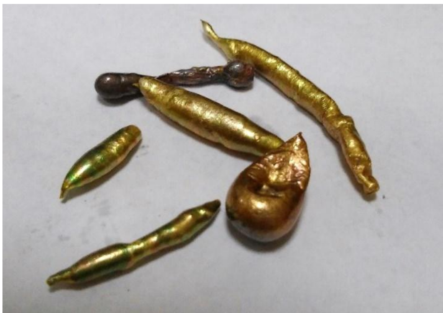
Рисунок 8. Отливки серебра. Условия - m_{Ag} - 20 г, 3л воды и 50 мл масла, скорость средняя
