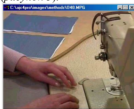
Рисунок 3. Фрагмент видеоклипа операции стачивания двух деталей
