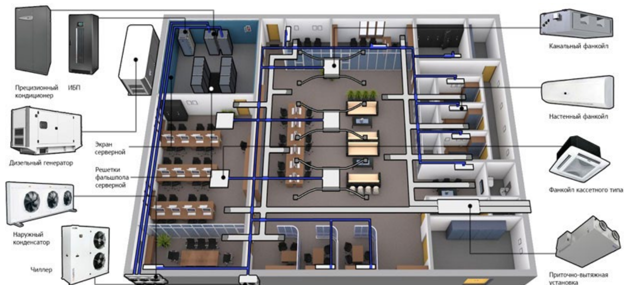
Рис. 3. Схема устройства системы чиллер – фанкойл.
