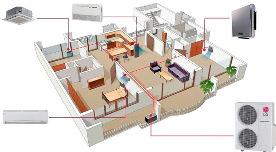
Рис. 2. Схема устройства мульти-сплит системы.
