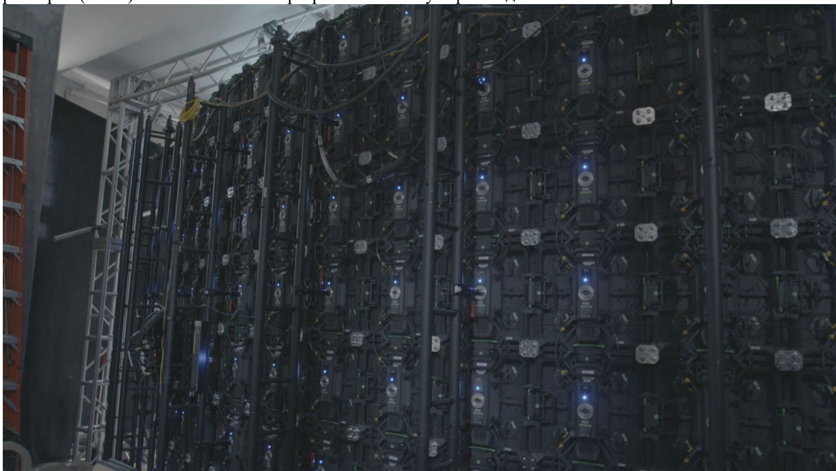
Рис. 8. Светодиодная конструкция состоит из массива панелей, которые могут быть расположены в любой конфигурации. На этом изображении показана задняя часть секции светодиодных панелей.
