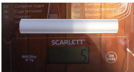
Рис. 3. Вес образца после пятого цикла испытания
