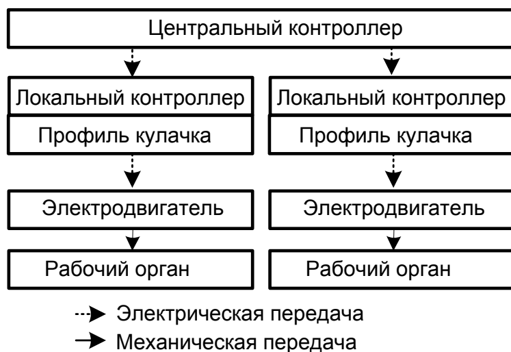
Рис. 1. Электронно-механический принцип управления
