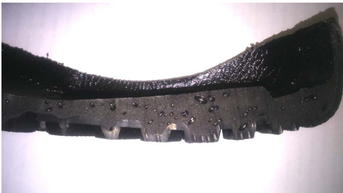
Рис. 4. Пористые включения в структуре подошв
