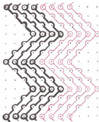
Рис. 2. Структура переплетения атлас
