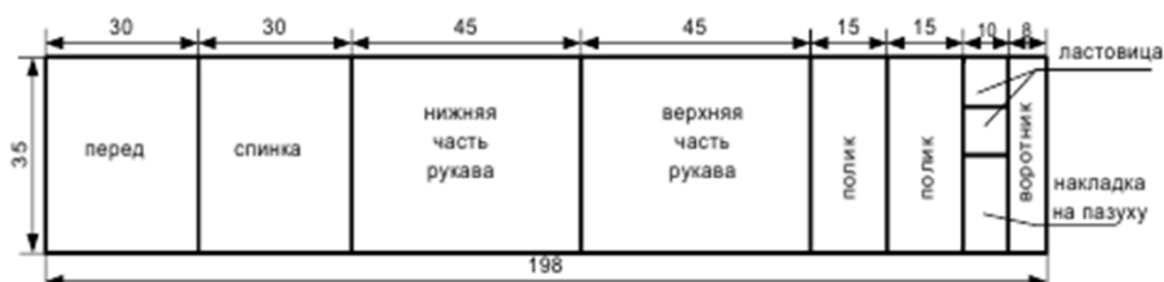
Рис. 1. Схема кроя рубахи из домотканого полотна без остатков
