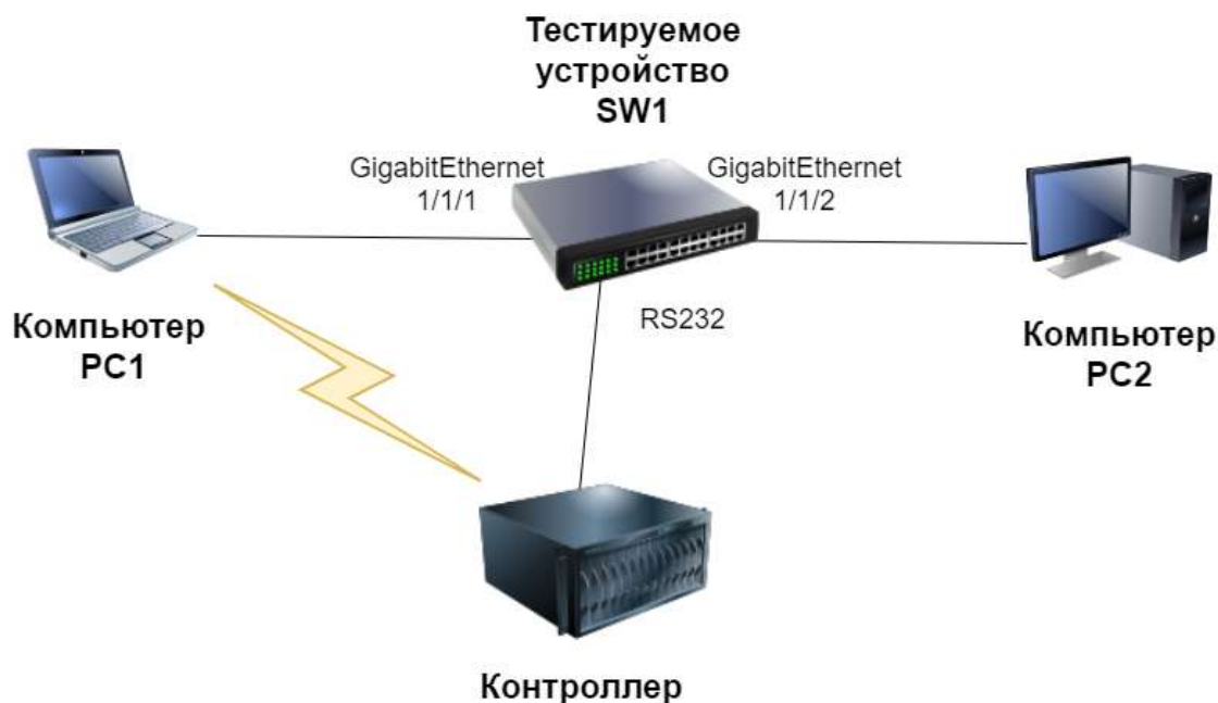
Рис.1. Стенд для тестирования Static ARP Inspection
