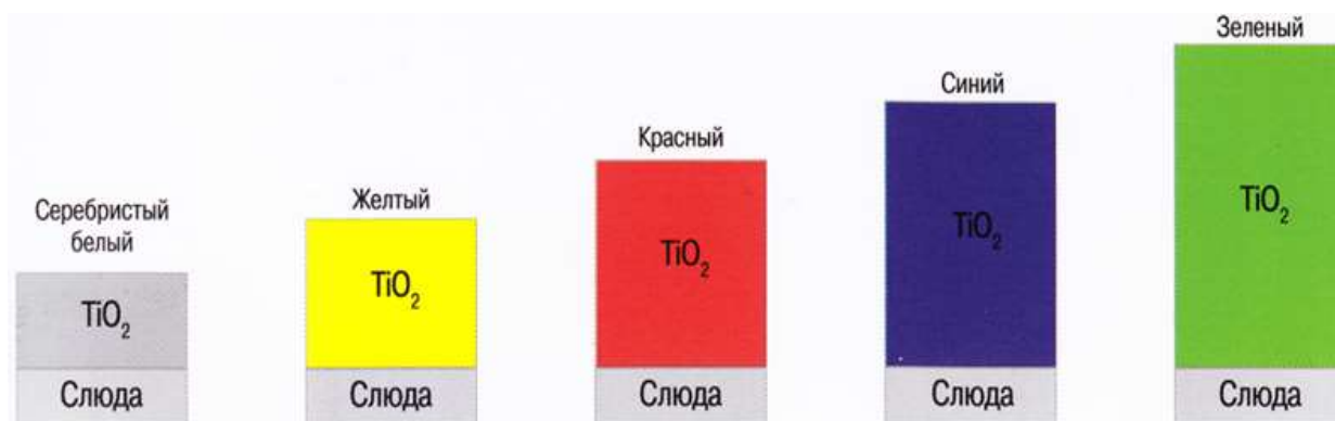
Рисунок 2 – Принципиальная схема получения различных цветовых эффектов при использовании диоксида титана в качестве интерференционного пигмента
