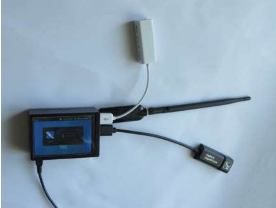
Рис. 1. Развёрнутая станция на базе одноплатного компьютера Raspberry Pi 3 с установленным дистрибутивом Kali Linux.
