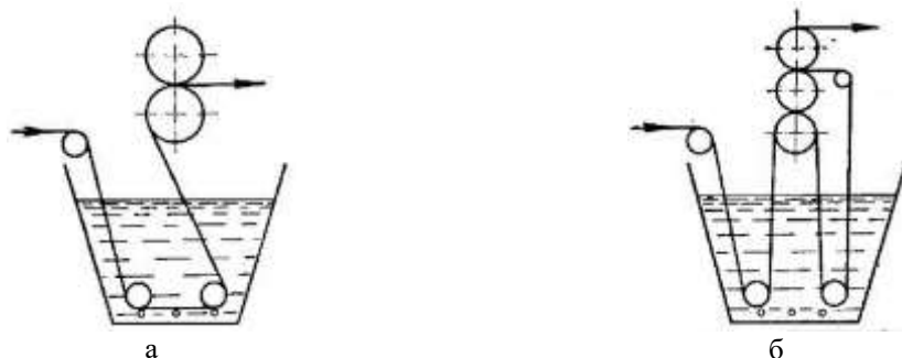
Рис.1. Схема плюсовок: а - двухвальная, б - трехвальная
