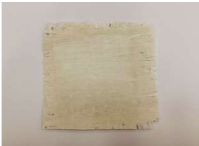
Рис. 8. Композит со смолой КФЖ
