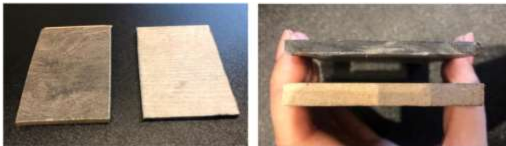
а б (Рис. 3.) Образцы ламината и плитки ПВХ до испытаний: а – общий вид, б – толщина.
