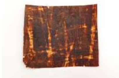
Рис.2. Композит с ФФС по технологии прокапывания (сторона 1)
