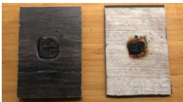
(Рис. 9.) Общий вид образцов плитки ПВХ и ламината после испытания.
