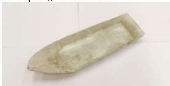
Рис.11 Лодочка стеклопластиковая (вид сверху)
